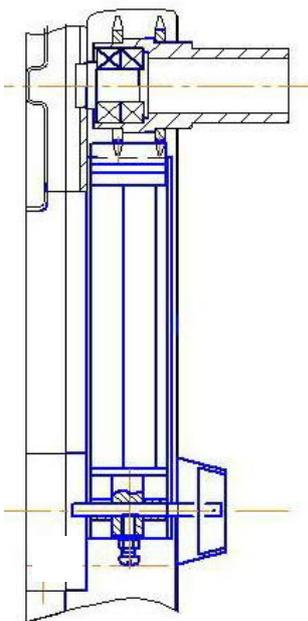
Стопорный механизм (стопор) представляет собой комплект пластин и направляющих, способных при установке механизма в положение фиксации удерживать передвижной блок весом до 10000 кг (включая вес документации) от возможного самопроизвольного перемещения в обе стороны. Стопорный механизм блокирует посадочную ось штурвал, как наименее нагруженную деталь привода.
