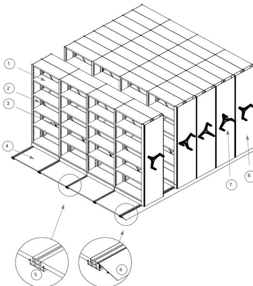
Рис. 1 Конструкция стеллажей серии «Л» с фальшполом.
