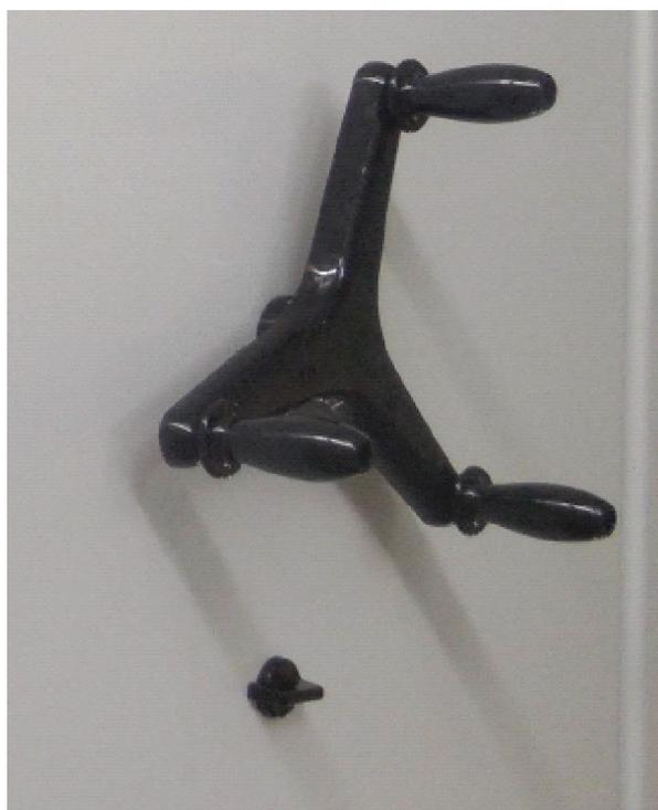
Фото 2. Штурвал и ручка стопорного механизма
