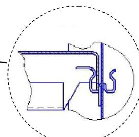
Двусторонний клип для установки полки на стойку.
