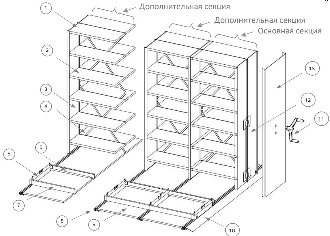
Рис 2. Пояснения к конструкции. Серия «Л» с фальшполом.
