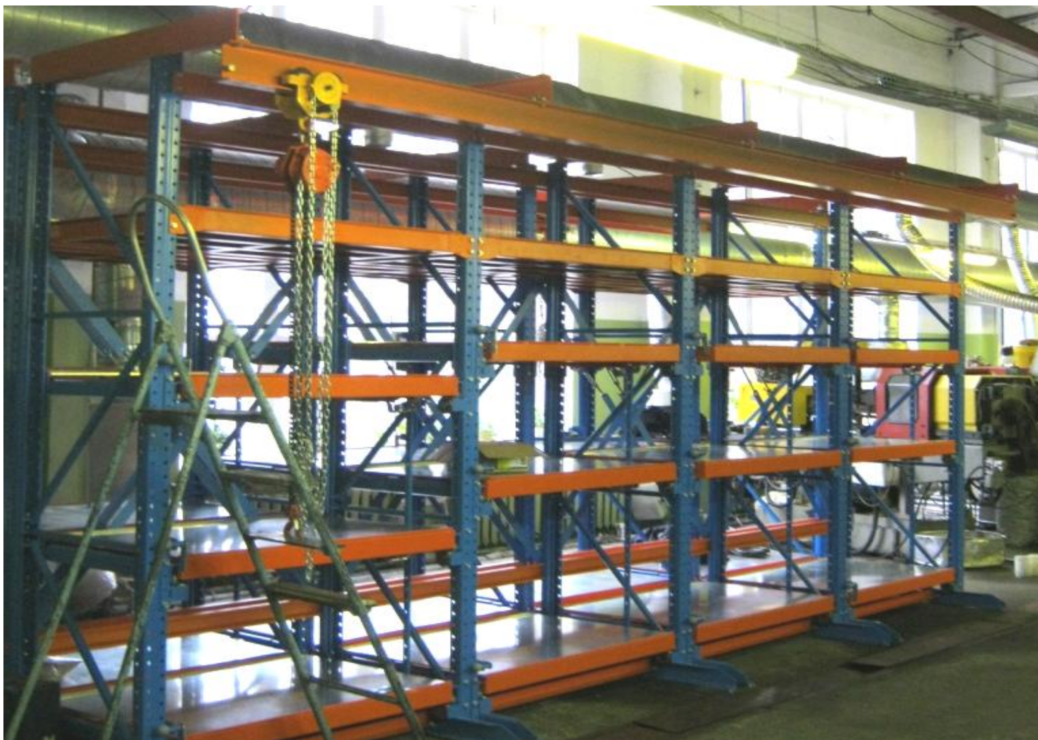
Стеллажи серии Slide со встроенной талью. Одна таль обслуживает несколько секций. Выдвижные полки в соседних секциях установлены на разной высоте с учетом габаритов хранимого груза.
